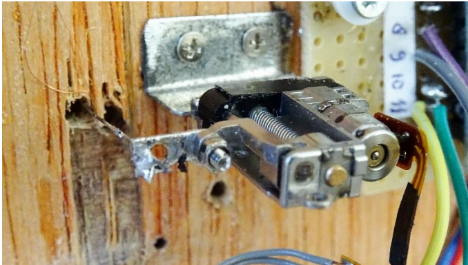
Stappenmotor met as en metalen L-profiel
