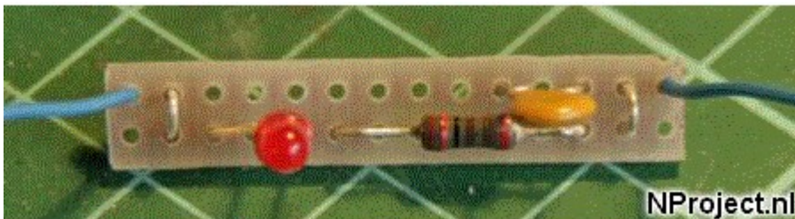
Kortsluitbeveiliging met PTC, rode LED en weerstand van 2k2 Ohm.
